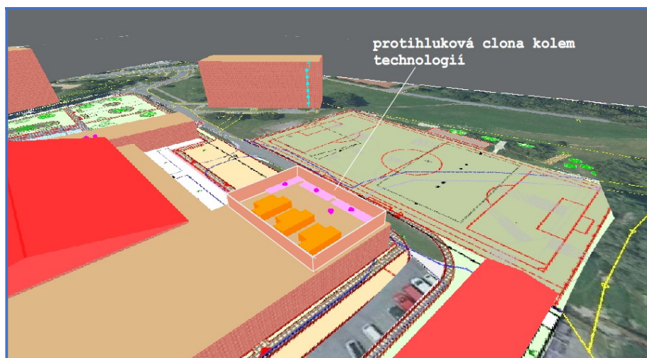
Obrázek č. 2 Schéma protihlukových opatření ve výpočetním modelu
